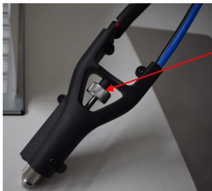
Sulla pistola di incollaggio, regolare la quantità di colla che si desidera erogare utilizzando l'apposita rotella: in senso orario, si riduce la quantità di colla; in senso anti-orario, si aumenta la quantità di colla
