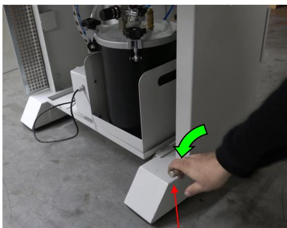
Abbassando questa leva, la macchina appoggia sulle ruote...
