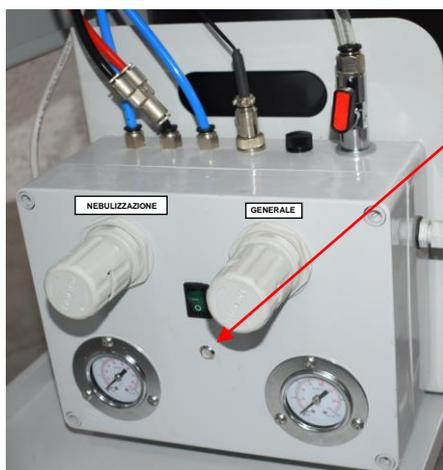
Lampada di segnalazione bianca sul quadro elettro-pneumatico: quando viene premuto il pulsante posto sulla pistola o il pedale che permette di erogare la colla, sotto forma di nebulizzazione, esso si illumina
