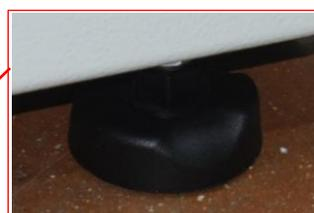
**Figura 16 – Piedi di appoggio a terra della macchina**
