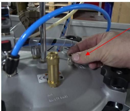
Scaricare la pressione residua, svitando leggermente la valvola di sfiato (AIR RELEASE VALVE) posta sul coperchio del serbatoio...
