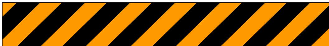
**Figura 1 - Esempio di colorazione per segnalazione di una zona pericolosa - ostacoli**
