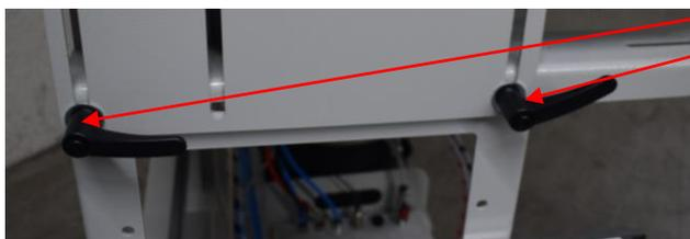
**Su entrambi i lati della macchina e contemporaneamente**, allentare (girando in senso anti-orario) entrambe le due maniglie per regolare il piano in altezza, alzandolo o abbassandolo
