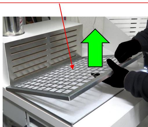
Rimuovere il filtro sporco o otturato e, se necessario, sollevare anche la grata metallica inferiore ed inserire sotto di essa un secondo filtro
