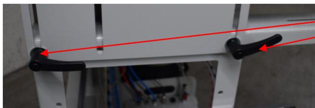
**Su entrambi i lati della macchina e contemporaneamente**, allentare una sola delle due maniglie per regolare l'inclinazione del piano di appoggio in avanti o all'indietro
