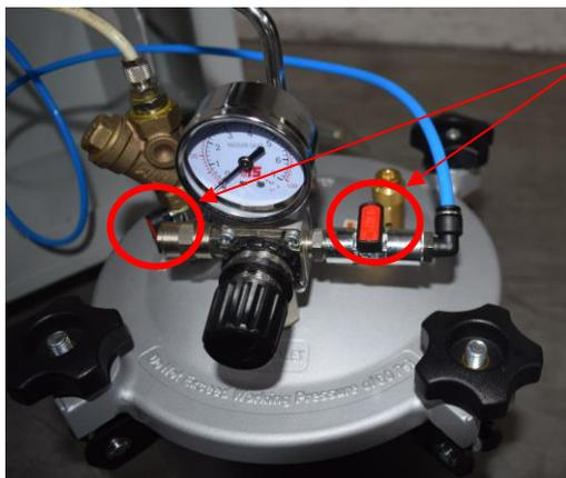
Chiudere il rubinetto di ingresso secondario dell'aria compressa per la colla e il rubinetto della colla, posti sopra il serbatoio
