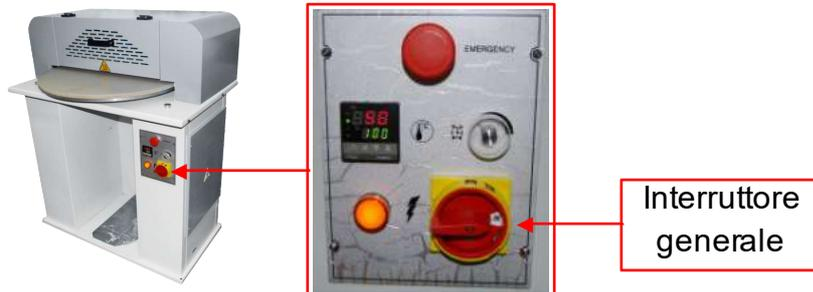
Per alimentare (abilitare) la macchina, agire sull'interruttore generale girandolo e portandolo nella posizione I-ON (macchina alimentata), mostrata in figura.
