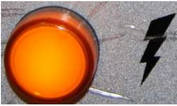
Lampada presenza tensione di alimentazione: di colore giallo, si illumina quando si pone in posizione I – ON l'interruttore generale, ed indica che la macchina è alimentata.
