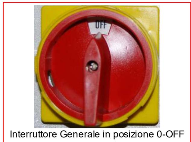
L'interruttore è munito di tre asole che sono attive quando esso è in posizione 0-OFF. Ogni asola consente di bloccare l'interruttore meccanicamente, tramite un lucchetto; questa operazione viene eseguita per effettuare la manutenzione o per inibire l'uso della macchina.
