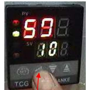
Premere il tasto in figura per fare lampeggiare le cifre della temperatura impostata: ad ogni tocco il lampeggio si sposta ad un'altra cifra
