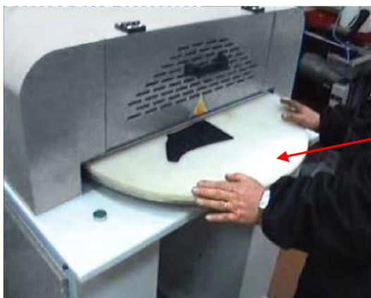
...e ruotare il piano di 180° per portare il materiale sotto la pressa
