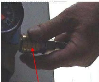
Per disconnettere l'alimentazione pneumatica e scaricare i circuiti, tirare la valvola a corsoio verso l'esterno...
