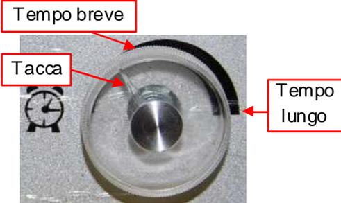
Manopola di regolazione tempo di pressata: girando la manopola in un senso o nell'altro (spostamento della tacca in figura), si regola la durata temporale della pressata (tempo in cui la pressa schiaccia pelle e rinforzo sul piano di lavoro), prima di tornare automaticamente in posizione alta di riposo.
