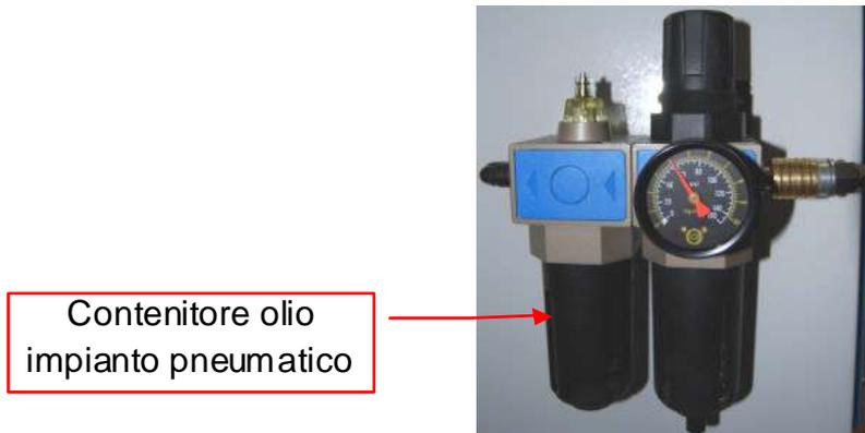
Se il livello è sceso al di sotto del minimo, è necessario provvedere al rabbocco, seguendo quanto riportato nello specifico paragrafo.
