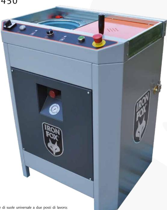
Assemblatrice di suole universale a due posti di lavoro; questa macchina è particolarmente adatta alla pressatura di suole tipo Opanka e con bordi molto alti che sarebberò quasi impossibili da pressare con macchinari tradizionali. Brevettata
